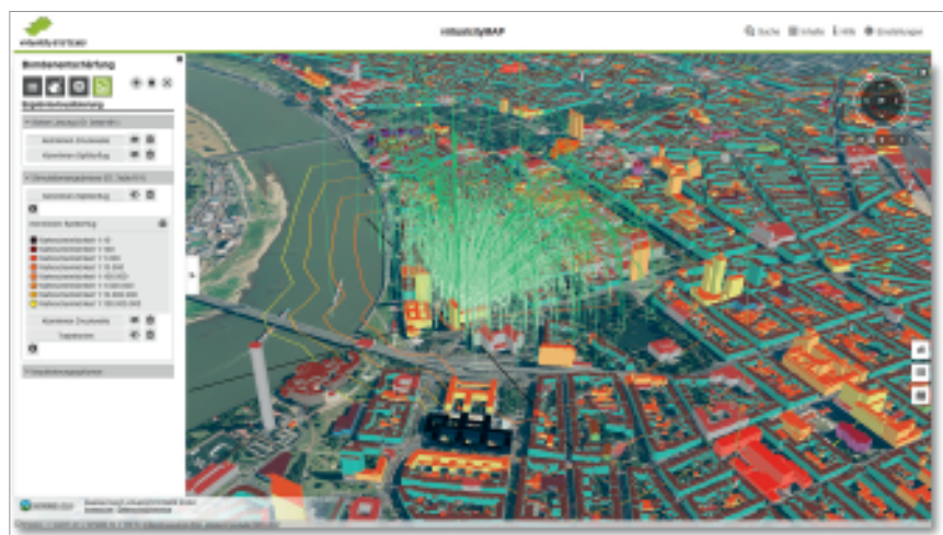
Abbildung 1: Virtuelle Simulation des berechneten Splitterfluges. Bild: Fraunhofer EMI
